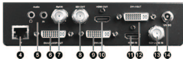
4=イーサネットIP 5=オーディオIn/Out 6=DVI-Dループ 7=Ref In (Genlock) 8=SDI出力 9=DVI-D In 10=HDMI出力 11=HDMI IN 12=DVI-D出力 13=SDI/CVBS In 14=12VDC
