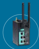
OnCell G3470A-LTE シリーズ 4ポートイーサネットスイッチ接続を備えたセルラールータ
