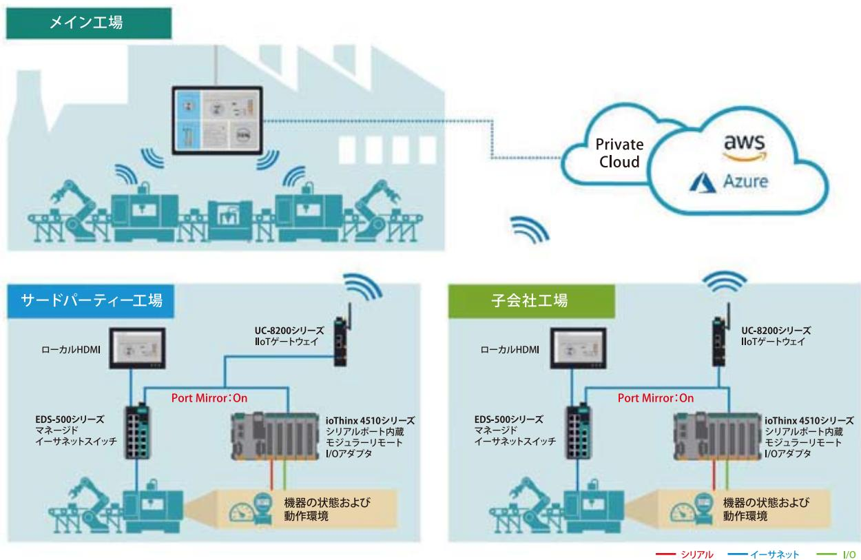
MoxaのIoTゲートウェイは、ModbusをMQTTおよびクラウドサービスで使用される他の一般的なプロトコルに変換することもできます。これにより、製造業者は自社のデータをクラウドに迅速にアップロードし、主要工場のシステムとさらに統合することができます。このようにして、メインファクトリは下請業者からすぐにデータを取得できます。既存の生産管理システムと統合すると、最大の効率でリモート管理を実行できます。
