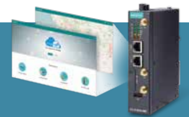
UC-8100A-ME-T シリーズ OT/IT コネクティビリティのためのオプションの ThingsPro® ソフトウェアを搭載した Arm ベースのエッジコンピュータ
