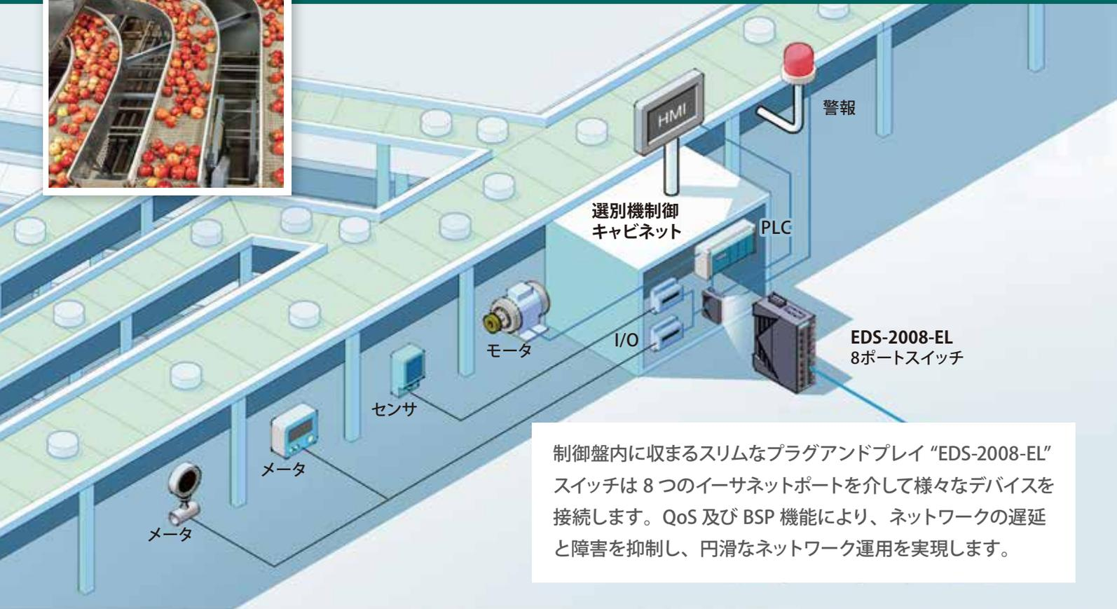
制御盤内に収まるスリムなプラグアンドプレイ“EDS-2008-EL”スイッチは8つのイーサネットポートを介して様々なデバイスを接続します。QoS及びBSP機能により、ネットワークの遅延と障害を抑制し、円滑なネットワーク運用を実現します。
