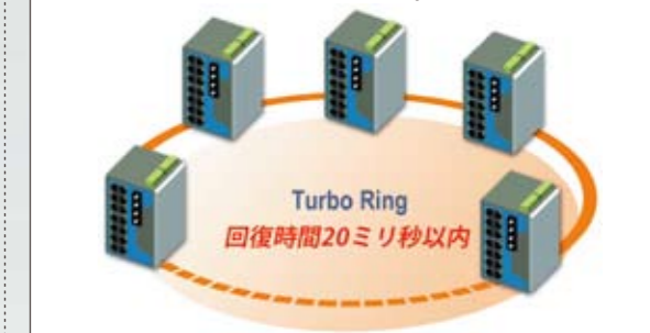
図3 MOXA社の高速リングトポロジ「Turbo Ring」
